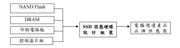
固態硬碟 SSD 是一種由 NAND Flash 晶粒組成的儲存裝置,由於具備低功率、耐用且輕薄等特色,對傳統硬碟 (HDD) 帶來威脅,但因 SSD 售價相對 HDD 高上許多,目前仍主要應用在高階機種上。i Suppli 預估,全球具備快閃記憶體的 SSD 出貨量在 2013 年將成長至到 6,820 萬台,到 2015 年更可直接上衝至 1.21 億台,SSD 的出貨量拉升也將帶動對 NAND Flash 的需求。
